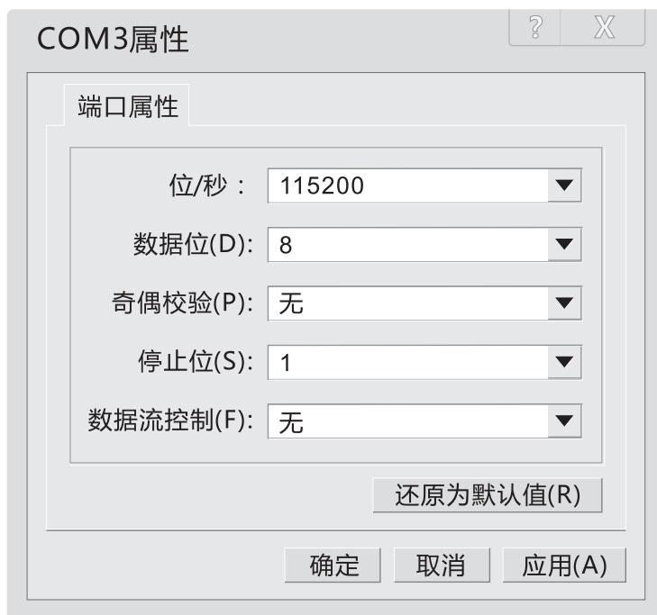
超级终端配置完成并正常运行后，再给DTU 通电启动。DTU 完成启动过程后（大约30 秒），在如下界面键入AT，应该回显OK，此时说明超级终端程序与DTU 连接成功，可以继续进行DTU的设置工作了。
